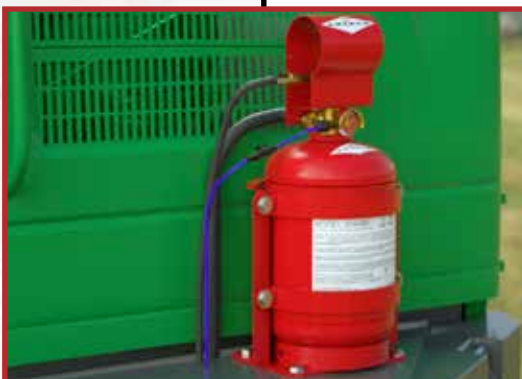
Cilindro de Agente Extintor
