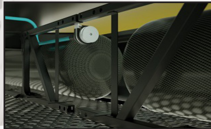
Sensor de gás no compartimento do cilindro
