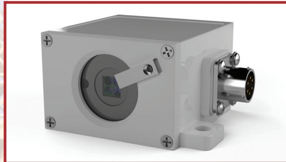
O detector infravermelho Kodiak IR3 é o detector de resposta mais rápido da indústria, respondendo ao incêndio em segundos. Resposta mais rápida significa menos danos e menos tempo de inatividade. Os detectores IR3 "veem" o incêndio reconhecendo os padrões de comprimento de onda de luz lançados pelo incêndio de hidrocarbonetos.
