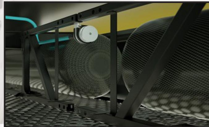
Sensor de Gas en el compartimento del cilindro
